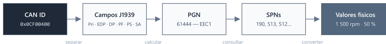
Figura 8.4 — A cadeia de interpretação de uma mensagem J1939, do identificador capturado ao valor de engenharia.
